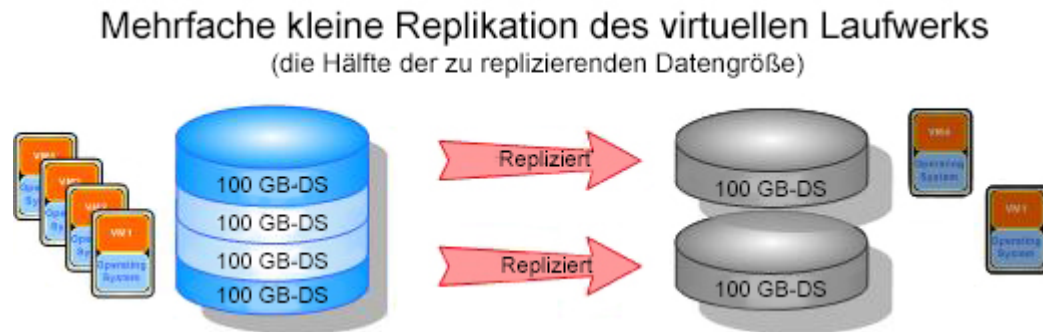
Abbildung 3. Replikation mehrerer virtueller Laufwerke
